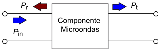
Figura 19. Balance de potencias en un componente de microondas de 2 puertos
