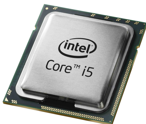
Figura 11: Processador i5 amb 4 nuclis
