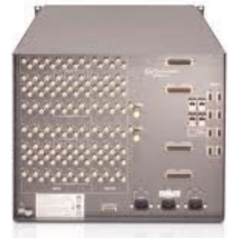
Connexions d'entrada i sortida d'una matriu de vídeo i àudio
