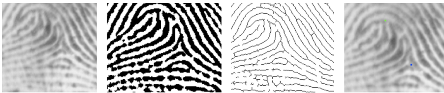
Figura 24. Esquema del proceso de detección de las minutiae
