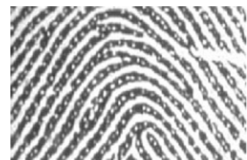
Figura 11. Imagen de un detalle de un dedo donde se pueden ver los poros de sudor. La imagen ha sido tomada a 1.000 dpi.
