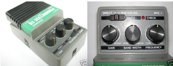
Figura 91. Módulo de filtro paramétrico para guitarra. Observad los tres controles de ganancia, ancho de banda y frecuencia
