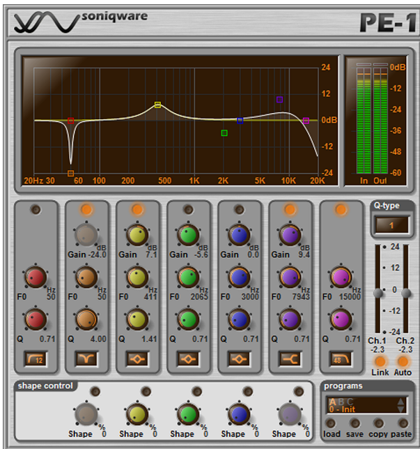
Figura 95. Ecuador paramétrico multibanda que incorpora un filtro paso alto y uno paso bajo
