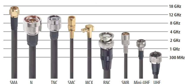
Ilustración 61: Tipos de conectores coaxiales .
