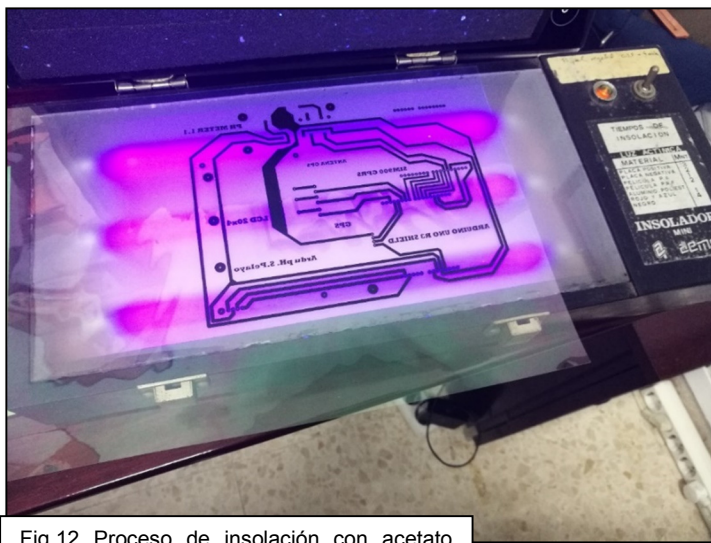
Fig.12 Proceso de insolación con acetato
