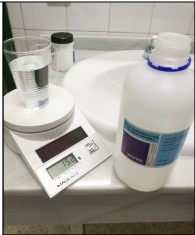
Fig.16 Atacador cobre – Ácido clorhídrico
