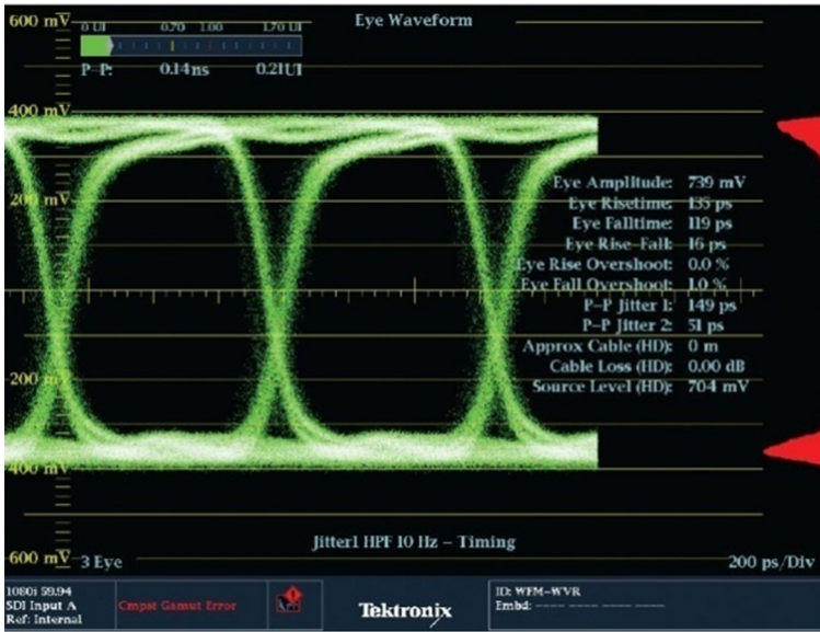
Figura 38. Trama de senyal pràcticament sense distorsió
