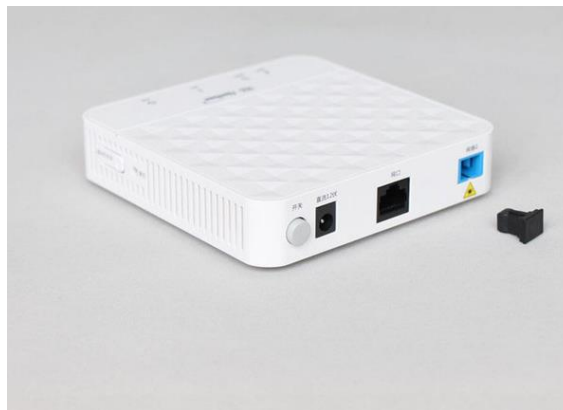
Il·lustració 10: Terminal de xarxa òptica ONT
