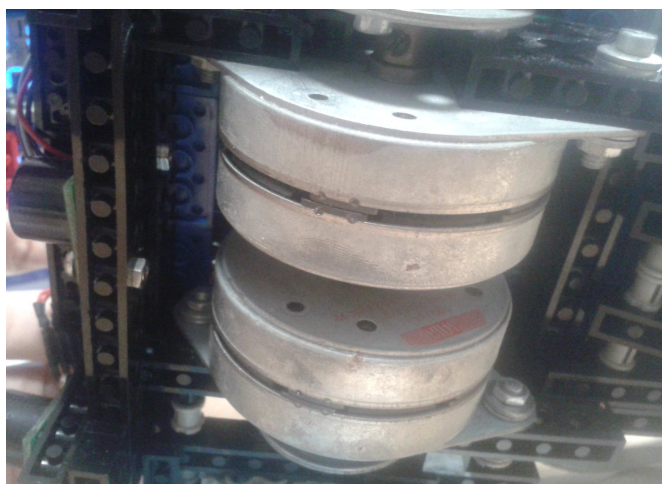
Figura 19. Detall dels motors Saia ukd34n04rnz3
