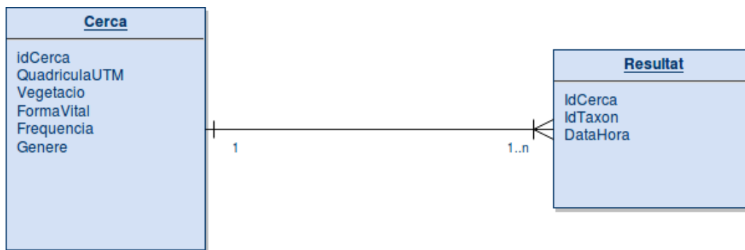
Figura 12: Diagrama UML corresponent al disseny de la base de dades del sistema d'ajut
