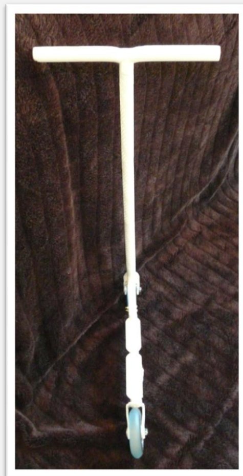
Il·lustració 21. Comprovació de muntatge i funcionament del prototip del patinet imprès
