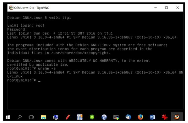
Es importante tener en cuenta que en este caso la MV 101 solo tiene NAT en su red y que en esta prueba el servidor Proxmox se está ejecutando como MV de KVM, pero con *bridge* de su conexión (IP 192.168.1.200). En la documentación se indica cómo introducir *passwd* y cómo hacer esta configuración definitiva (ya que con *Monitor* solo es temporal).
