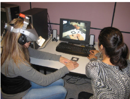
Figura 6.1. Equip de RA en el qual una càmera s'integra en els cascos Figura 6.2. Sensor de posició
