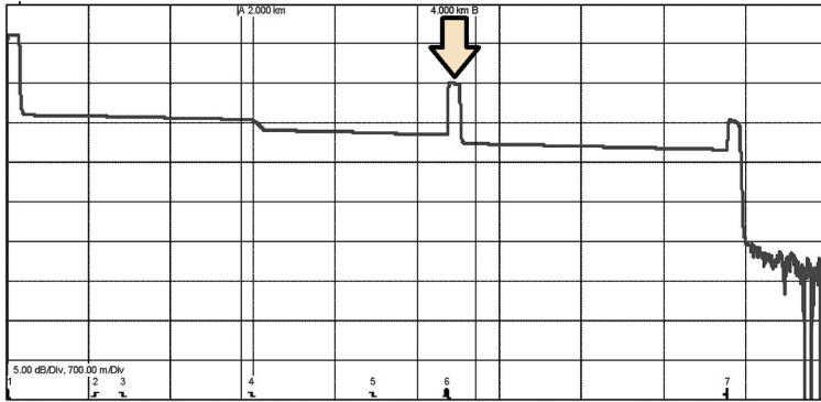
Figura 3. Representación de un acontecimiento reflexivo en la traza del OTDR
