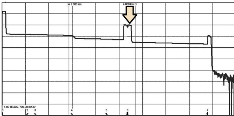
Figura 11. Representación de un acontecimiento oculto en la traza del OTDR
