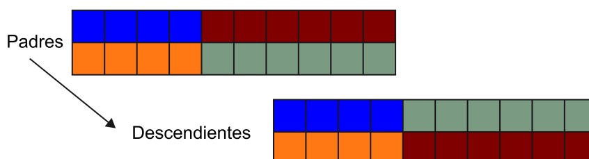
Figura 2. Ejemplo de funcionamiento del operador crossover
