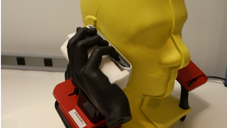
Figura 5. Testeo de antena en teléfono móvil considerando cabeza y manos phantom
