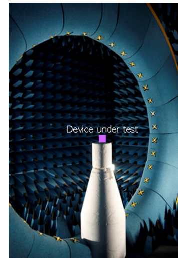
Figura 6. Cámara anecoica formada por un anillo con 31 sondas de doble polarización. Permiten medir un corte del campo radiado por el dispositivo bajo prueba. Para realizar la medida en 3D, el soporte central efectúa un giro en azimut, pudiendo realizar de esta forma medidas 3D. Gentileza de la empresa de tecnología Fractus, Barcelona
