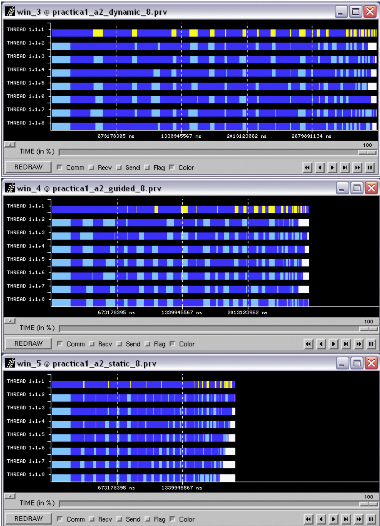
Figura 10. Trazas de la ejecución de una misma aplicación OpenMP con diferentes políticas de planificación para la distribución del trabajo
