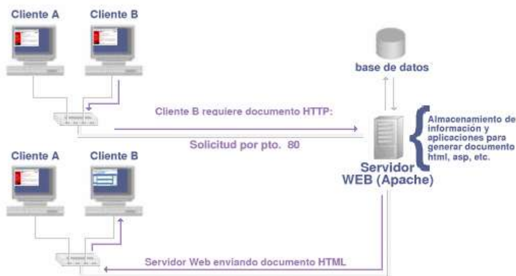
Fig: Esquema de funcionament d'un servidor web.
