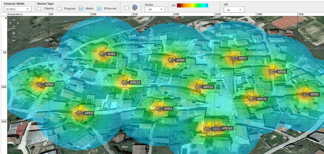
Figura 3.22: 5 GHz SNR Heat Map
