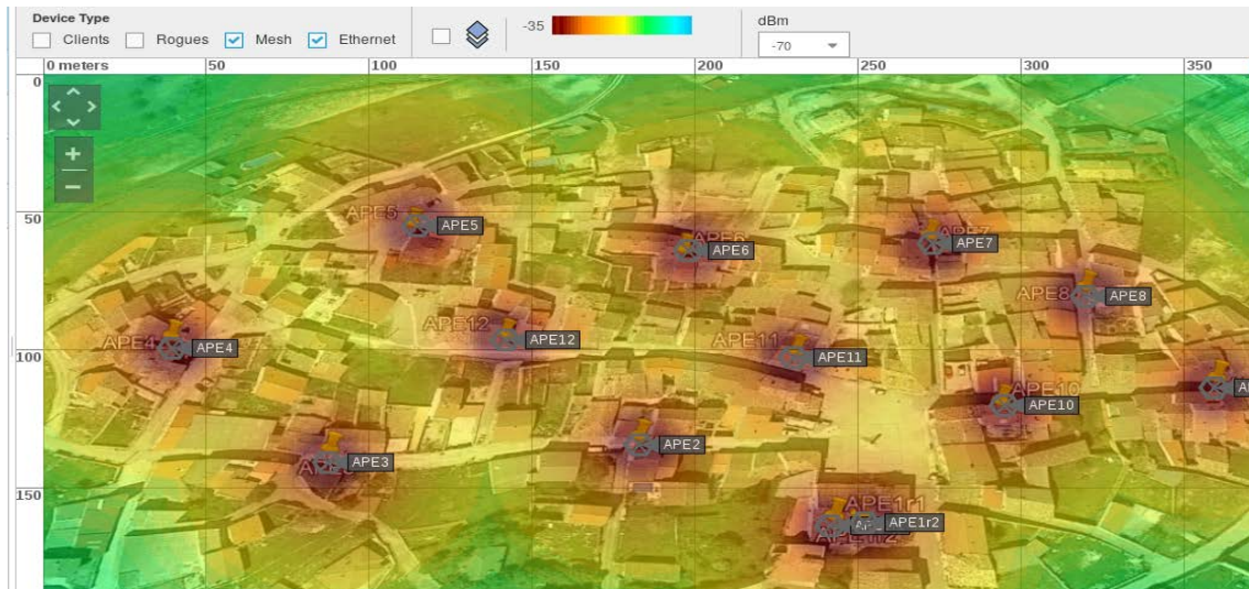
Figura 3.19: 2.4GHz RSSI Heat Map
