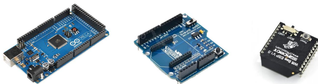
Ilustración 21: Arduino Mega, Escudo Bee, ESP8266 WifiBee
