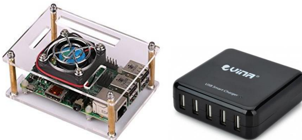
Figura 15: Raspberry pi 3 con caja apilable y cargador de alta potencia
