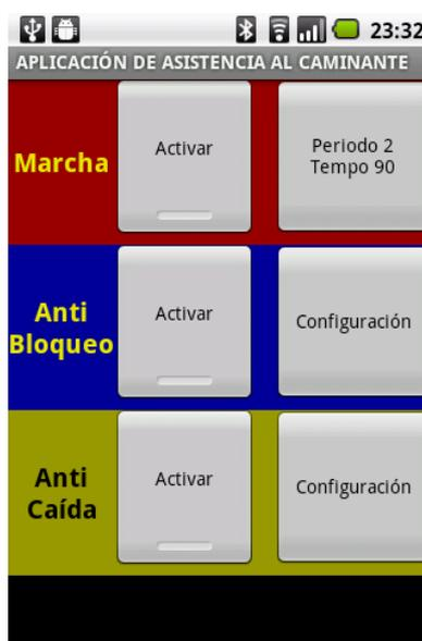
los tres botones (del tipo ToggleButton) para activar-desactivar las opciones que conforman la aplicación: Marcha, Anti Bloqueo y Anti Caída, y otros tres para cambiar algunos parámetros de configuración de sus correspondientes opciones. Los ToggleButton activos muestran una raya "iluminada" y cambia el mensaje de activar por parar.
