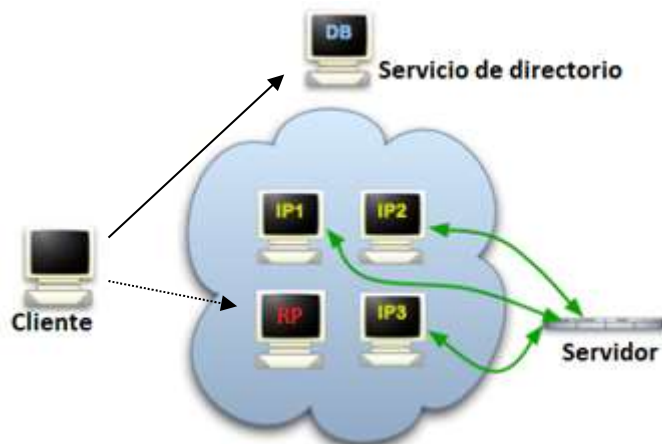
Figura 4: Escenario en que el cliente solicita el nombre del servicio al servidor de directorio y posteriormente se comunica con el punto de encuentro (RP, Rendezvous Point).
