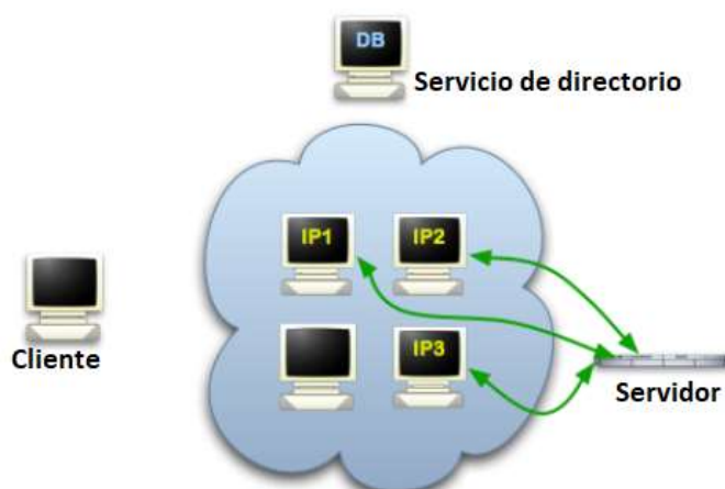
Figura 3: Escenario en que un cliente de la red TOR quiere realizar una petición a un servicio anónimo. Las líneas verdes representan las conexiones TOR (descritas en el apartado 2.1.1 de este documento) en que el servidor anuncia su servicio a puntos de introducción.
