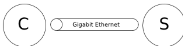
Figura 8. Arquitectura Cliente-Servidor a través de conexión GigaE directa
