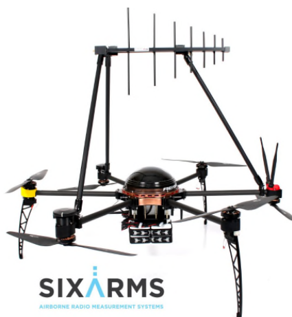
Figura 16. Imatge d'un dron de mesura de SixArms
