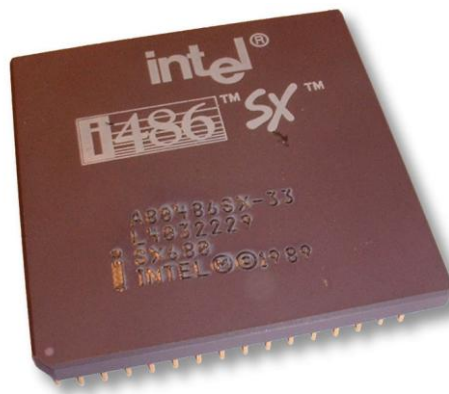
Figura 19. Detall d'un microprocessador Intel 80486 SX .
