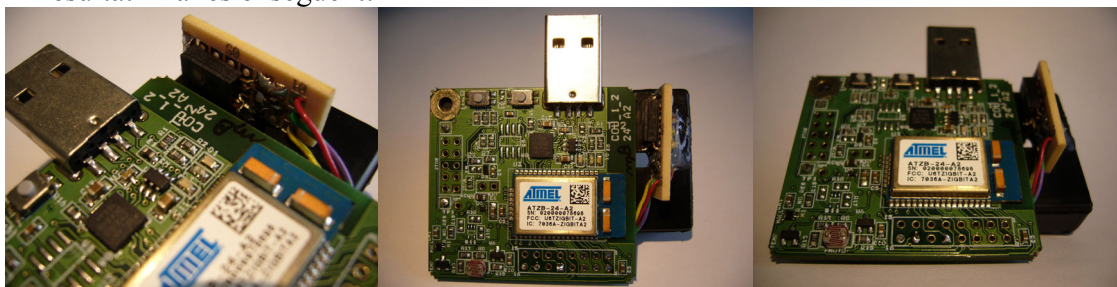
Figura 5.7. Imatges d'una de les motes amb el sensor d'humitat HIH-5031 d'Honeywell integrat
