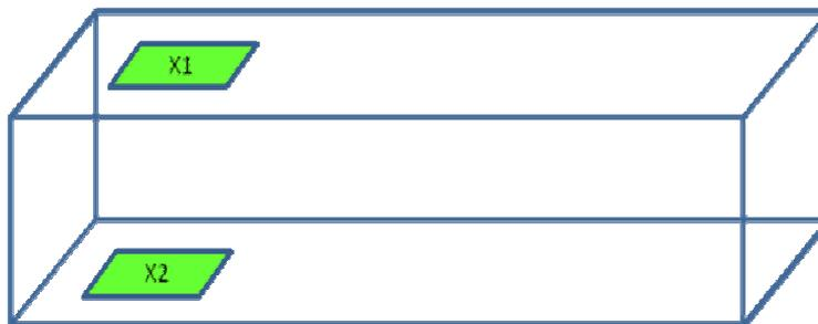
**Figura 3.8. Disposición de las galgas sobre el plano X**
