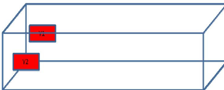
**Figura 3.9. Disposición de las galgas sobre el plano Y.**
