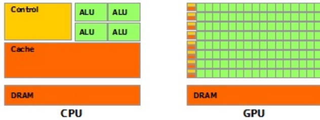
Figura 7: número de transistores para procesar datos en CPU y GPU 9 .
