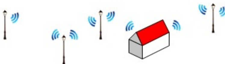
Il·lustració 1.2.3: Topologia multi-hop (reenviament de paquets)
