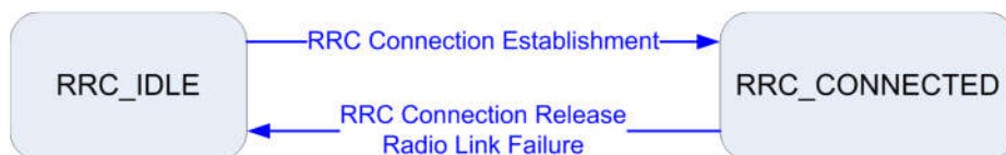
Figura 28. Modelo de los estados del RRC y sus transiciones [49]
