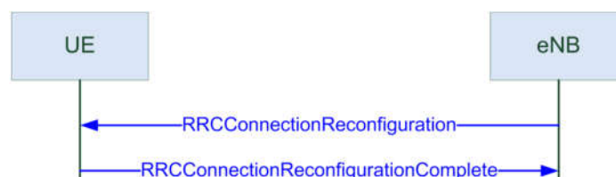
Figura 35. Procedimiento de reconfiguración de la conexión RRC [49]
