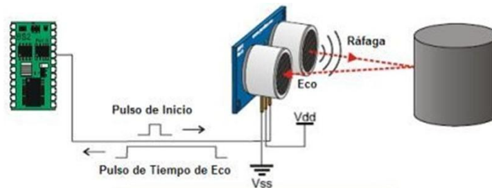
Figura 8. Esquema de funcionamiento de un sensor de ultrasonidos.
