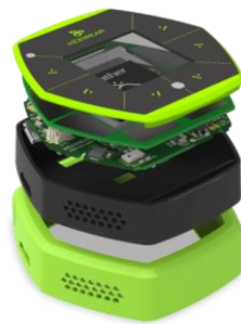
Ilustración 17:Desmontaje del dispositivo
