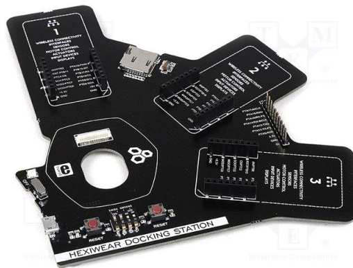
Ilustración 23: dock-station de Hexiwear
