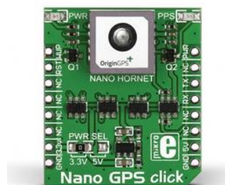
Ilustración 34: Click de expansión NanoGPS
