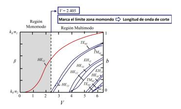
Este diagrama supone la curva de 'b' frente a 'V' para los modos que se propagan por la fibra, determinando el punto de la región límite de la zona monomodo, dependiente de forma directa de la longitud de la onda de corte.
