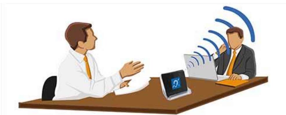
Figura 8. Representació esquemàtica d'un possible bucle d'inducció magnètica portàtil en un mostrador. Font: agilscomunicacio.com
