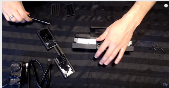
Figura 77: Desmuntatge de la carcassa de la Kinect
