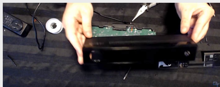
Figura 82: Muntatge de la carcassa de la Kinect
