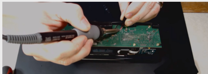
Figura 81: Soldatge dels cables de la Kinect
