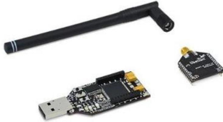
Figura 14. Módulo transceptor LoRa SX1272 y Concentrador LoRa [16]
