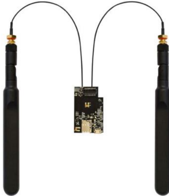
Figura 20. Módulo NB-IoT/LTE-M con sus antenas y apertura para nano-SIM de 3.4 dBi [29]
