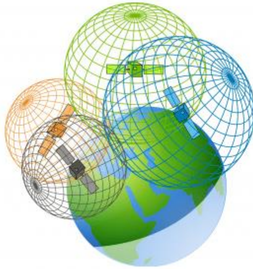
Figura 2. Determinación de la posición del receptor GPS [1]
