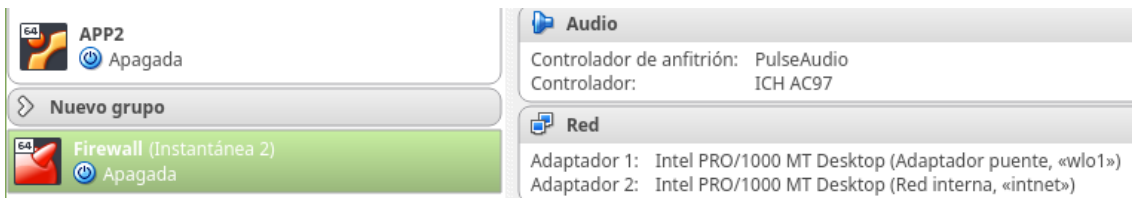
Figura 25 Configuración de los adaptadores de red del cortafuegos.
