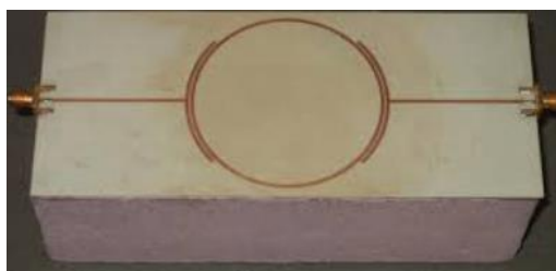
Figura 13. Ressonador en anell per al càlcul de la permitivitat relativa
