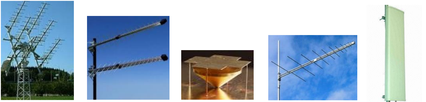
Figura 56. Antenes segons l'aplicació (de esquerra a dreta). Array de 6 antenes, sistema MIMOx2, antena miniatura, antena logoperiòdica i antena dual GSM-UMTS
