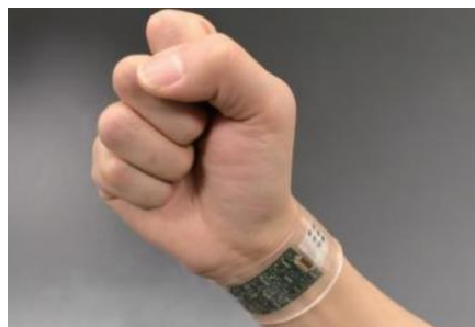
Figura 9. Sensor de monitoratge de sodi i glucosa
