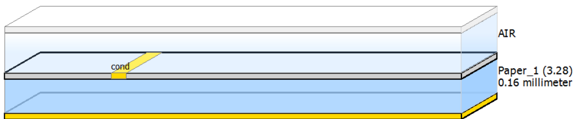
Figura 29. Disseny del substrat ( \epsilon_r = 3.28 , \tan\delta = 0.061 , d = 0.16\text{mm} )
