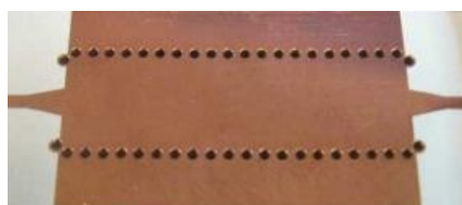
Figura 12. SIW dissenyat sobre substrat de paper
