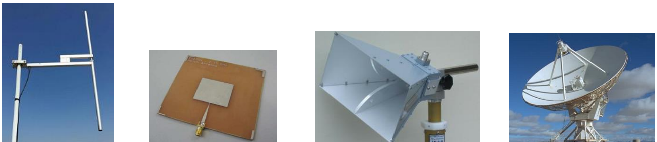
Figura 55. Antenes segons la geometria (de esquerra a dreta). Antena dipol, antena microstrip, antena de botzina i antena reflectora
