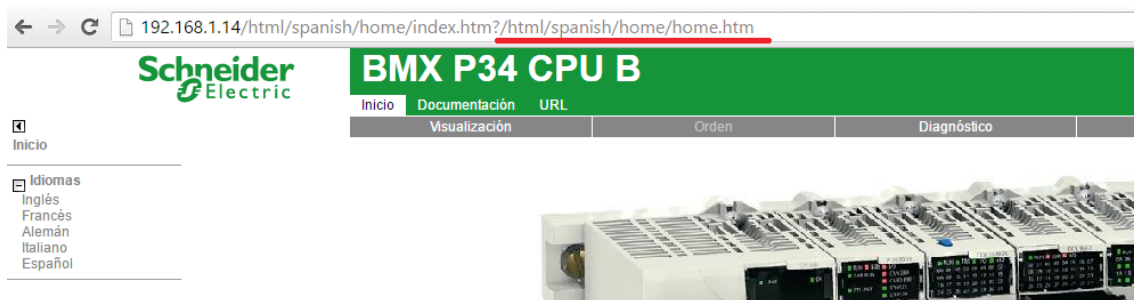
Ilustración 51 - LFI en la interfaz web de un PLC Schneider (Extraída de: [44])
