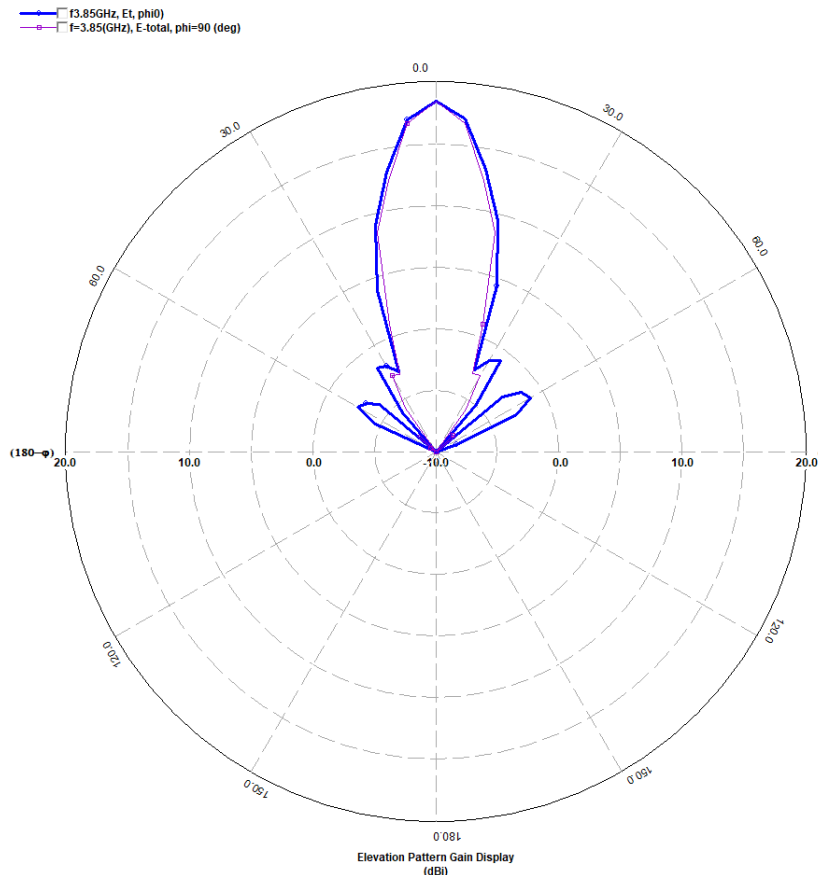
Figura 63. Diagrama de radiació de l'estructura a 3,85 GHz amb àrea 506mm x 528mm en IE3D
