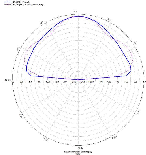
Figura 33. Diagrama de radiació de l'estructura a 3,85 GHz amb àrea 44mm x 39,6mm en IE3D
