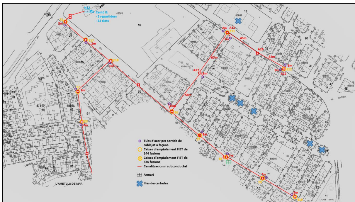
Il·lustració 18-Obra civil per la Xarxa d'accés del N12
