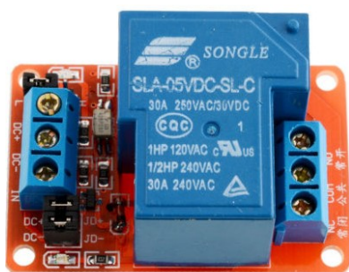
Il·lustració 18: Detall relé SLA-05VDC-SL-C amb optoacoblador
