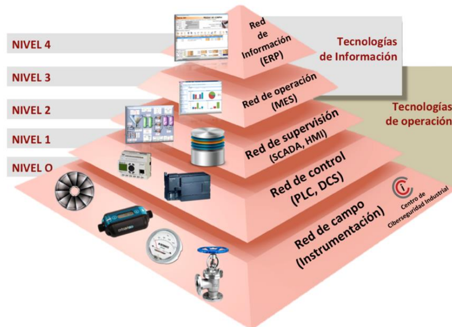
Arquitectura clásica de referencia: pirámide de automatización [1]
