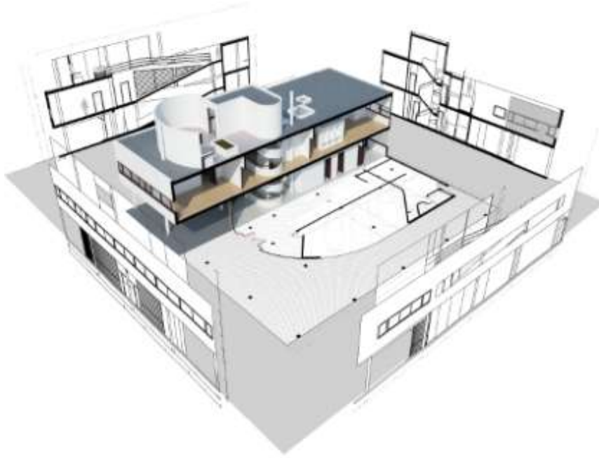
Figura 1: Modelo BIM de la Villa Savoye creado con VisualARQ
