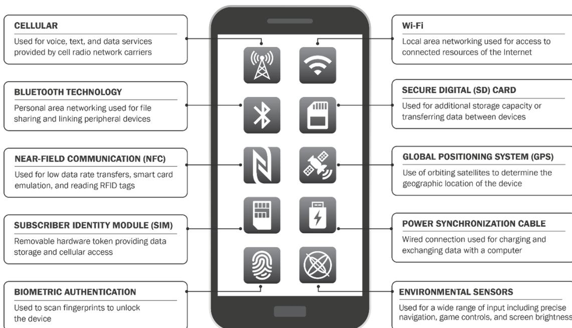
Figura 3 Interfaces de un dispositivo móvil
