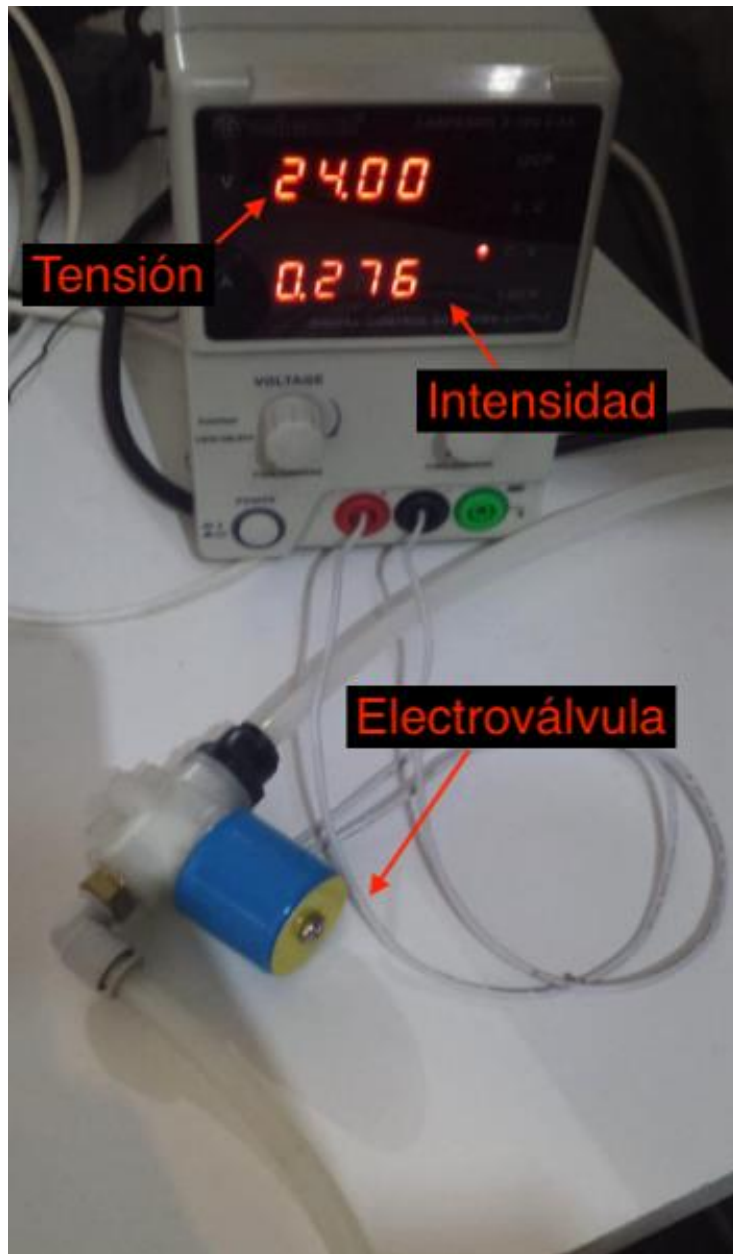
Figura: 57 Ley de Ohm en electroválvula
