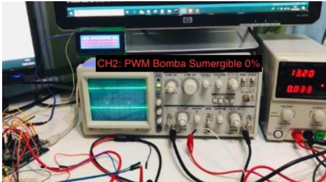
Figura: 85 PWM bomba sumergible al 0%
