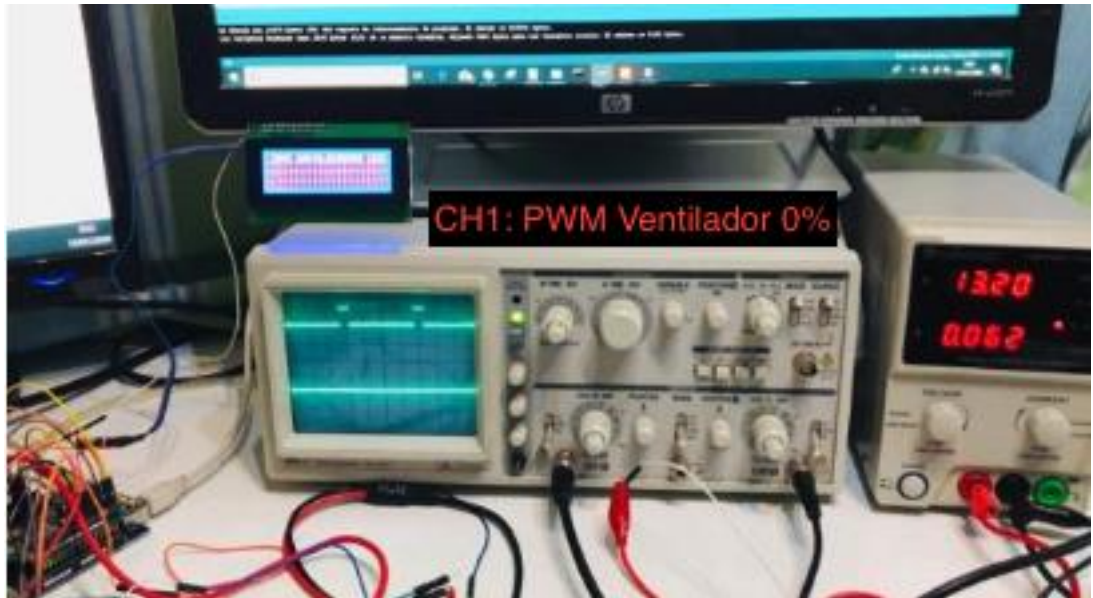
Figura: 83 PWM del ventilador al 0%
