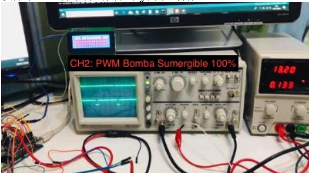
Figura: 84 PWM de la bomba sumergible al 100%
