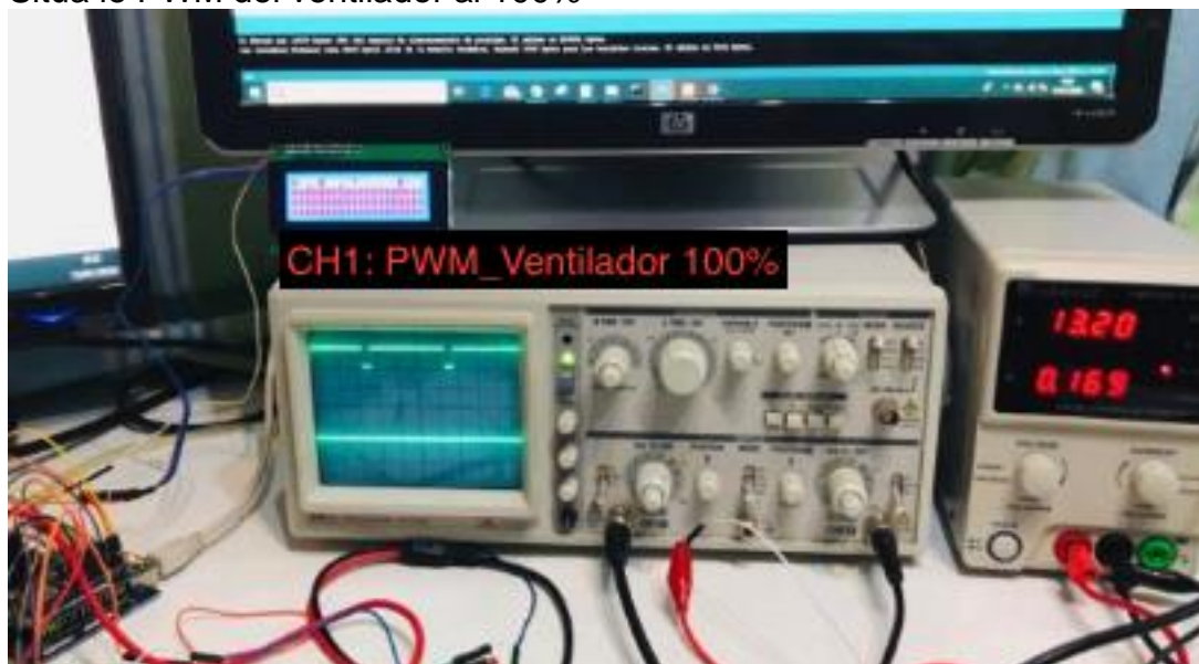
Figura: 82 CH1: PWM del ventilador al 100%
