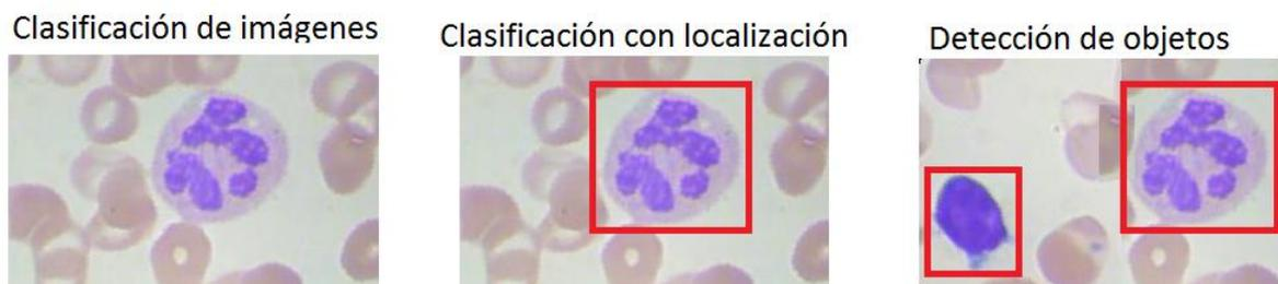
Figura 17. Algunas formas de visión por computador: Clasificación de imágenes (izquierda), clasificación con localización (centro) y detección de objetos en una imagen (derecha). Fuente: el autor.
