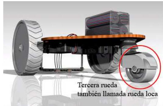
Figura 4. Robot velocista configurado en forma de triciclo.
