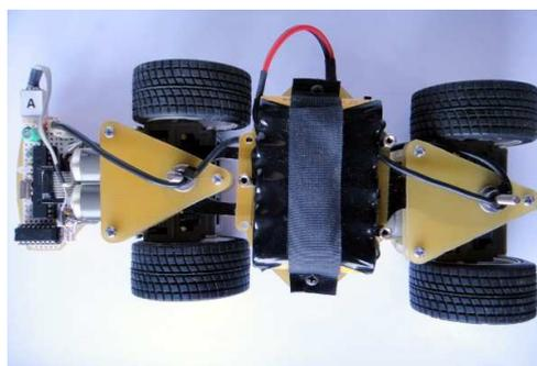
Figura 36. Robot AIVV completamente montado, donde puede verse el circuito de control del agente A. El agente B queda oculto por el paquete de baterías.
